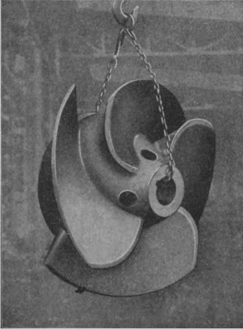
Abb. 202. Propeller einer sehr großen Entwässerungspumpe von C. H. Jäger & Co.
